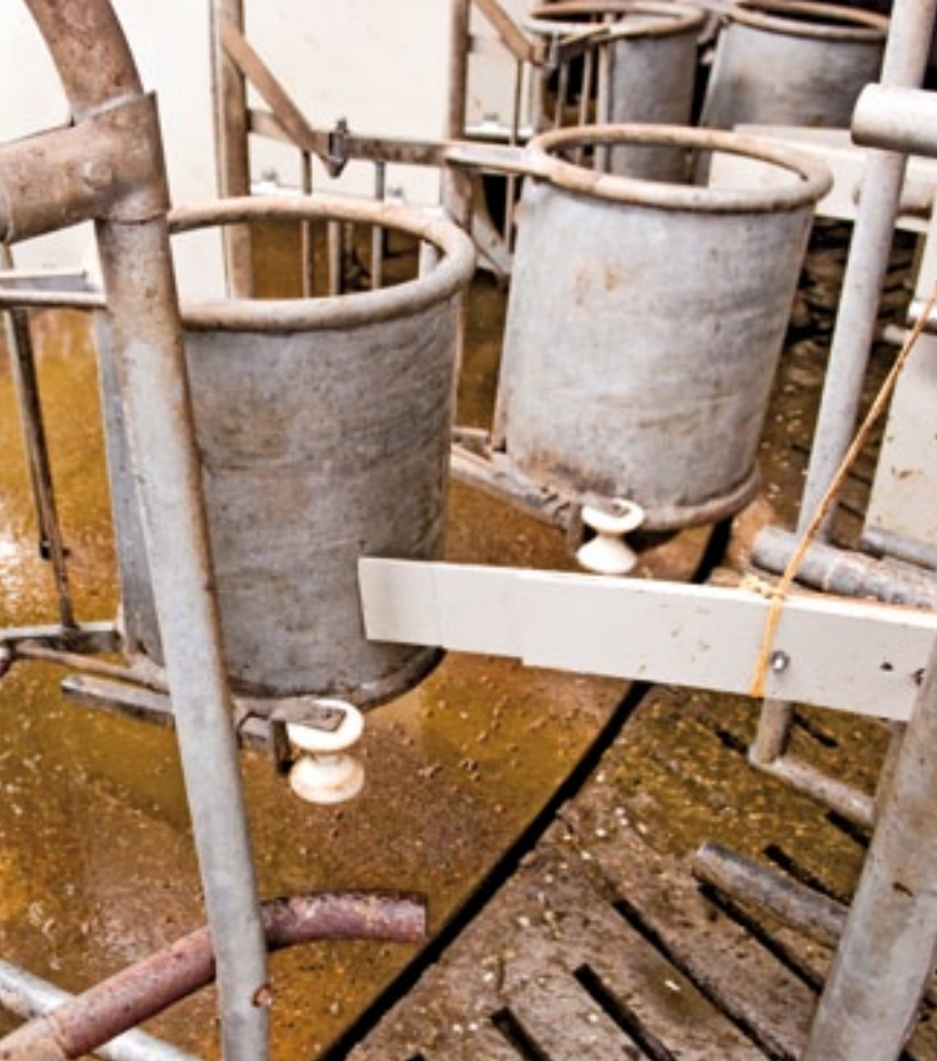
Een kunststof bladveer houdt de ronde voerbakken tegen en dempt zo de klap die de bak en de kunststof rol maken tegen de geleiderail.
