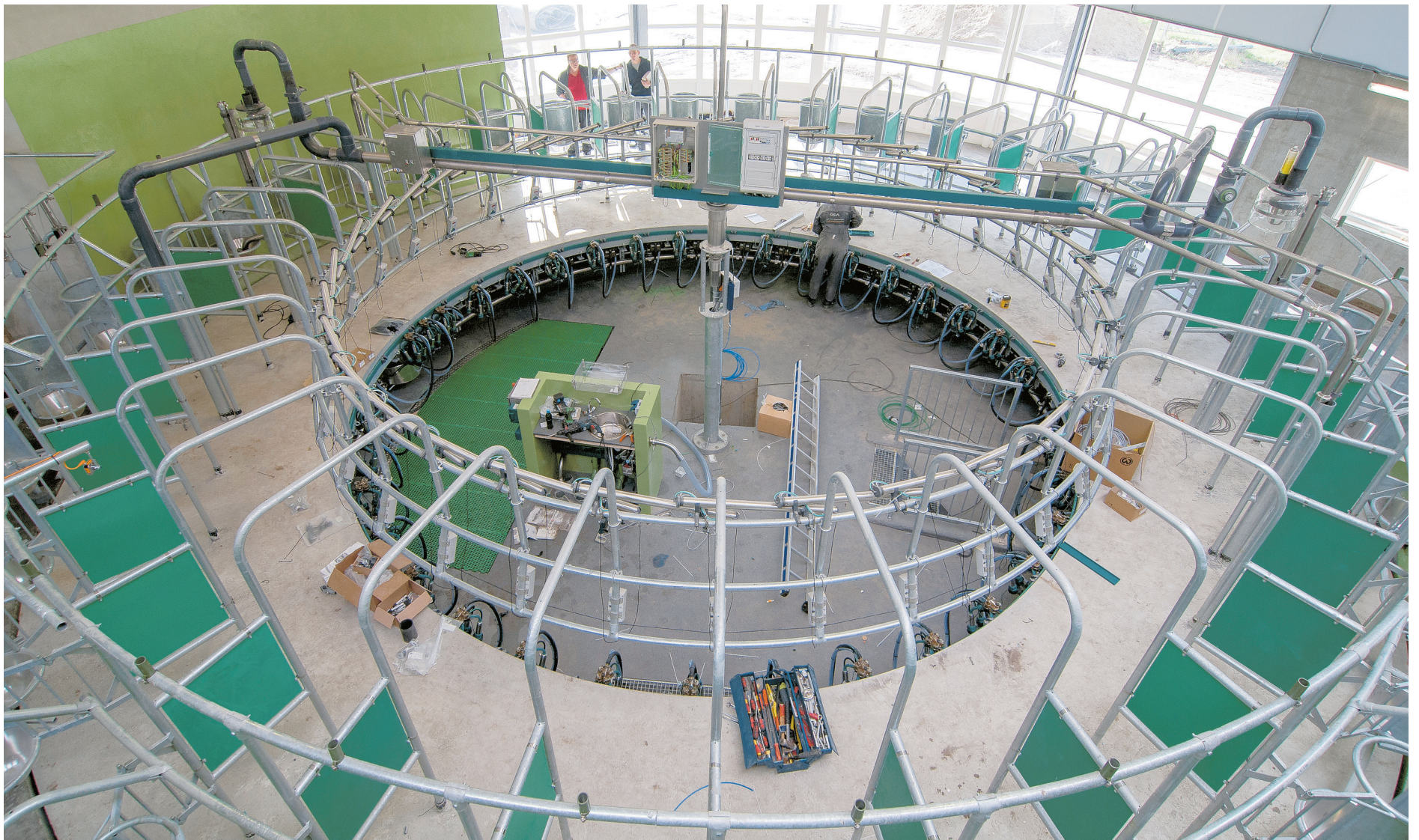
In de 3C-carroussel kan de koe het platform verlaten op het moment dat de voerbak wegklapt. Direct daarna stapt de volgende koe binnen.
